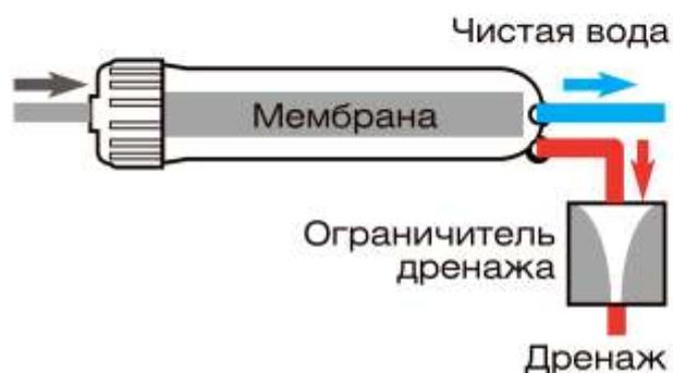
В системе **Гейзер-Престиж-П Люкс** система автоматически промывается интенсивным потоком воды, повышая эффективность очистки мембран.
