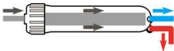
В **Гейзер-Престиж-П Люкс** после остановки фильтрации корпус мембраны заполняется чистой водой.
